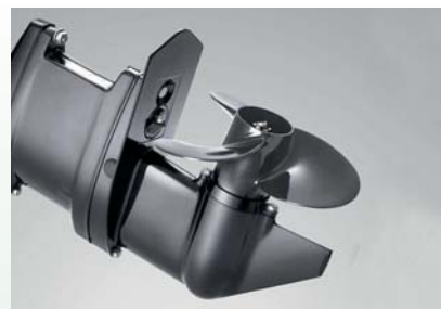
Pro plachetnice je jako pomocný pohon optimalizován model Tohatsu 6 Sail Pro, který má nohu s hřídelí dlouhou 20 nebo 25 palců a vrtuli uzpůsobenou vyššímu odporu a hmotnosti plachetnice. Tento motor je také standardně vybaven nabíjecím systémem 12 V/5 A včetně nabíjecího kabelu.
